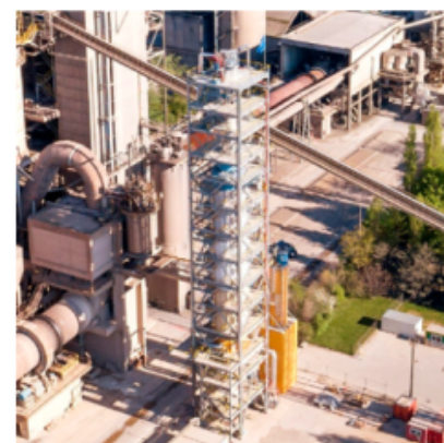
Calix 位于比利时的LEILAC示范项目先进的煅烧反应炉。图片来源：Calix
