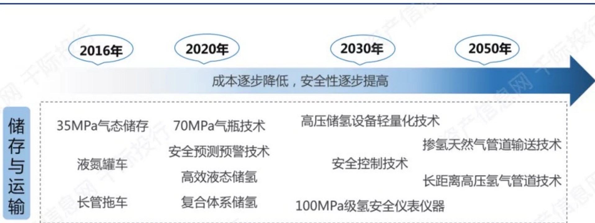
图 中国氢气储运发展路线图
