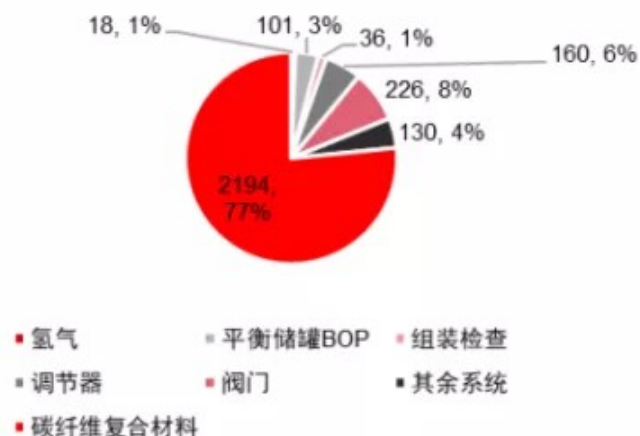
35MPa高压储氢IV型瓶中碳纤维材料成本占比约77%
