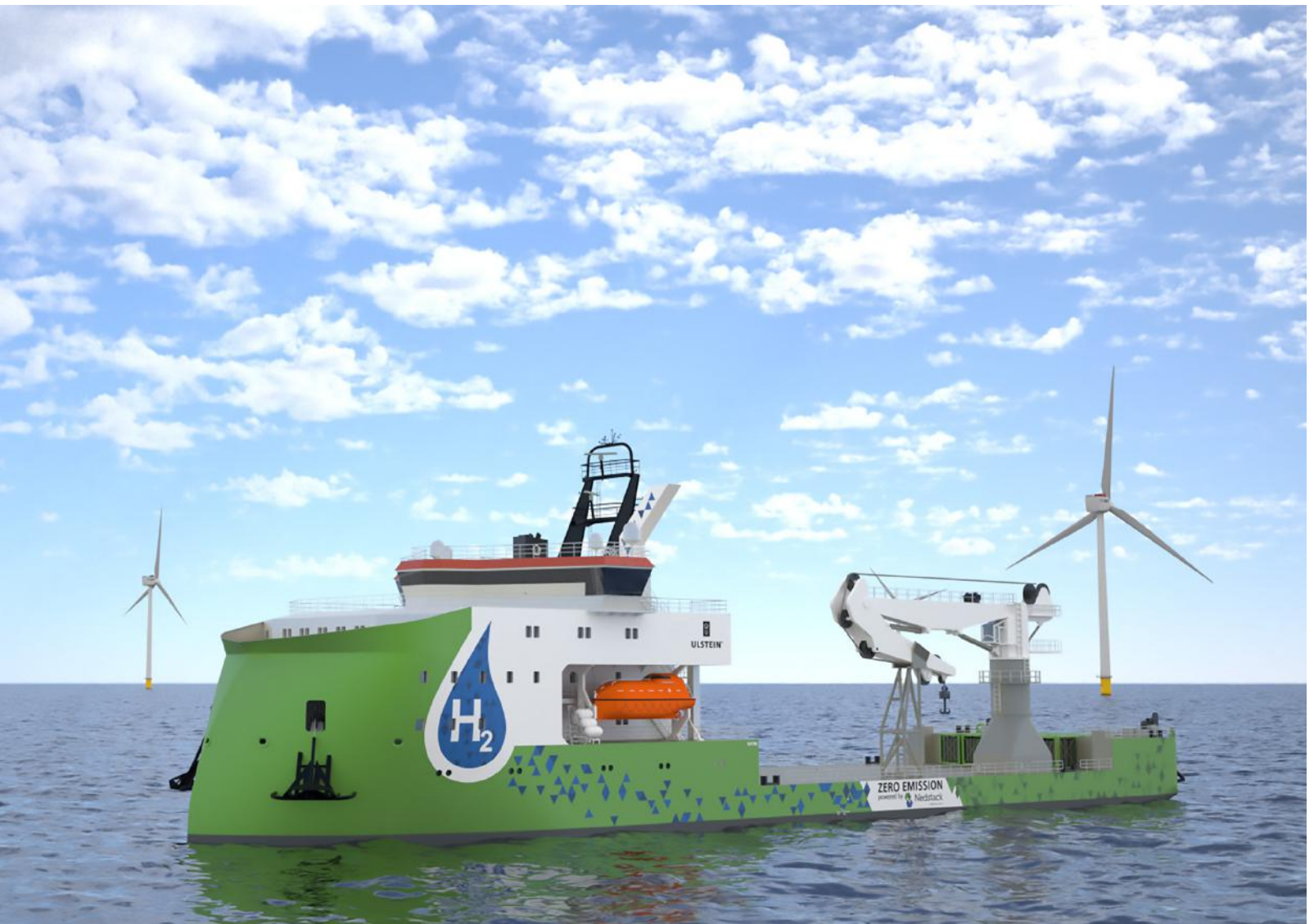
ULSTEIN SX190概念氢船—为海上施工市场的零排放作业而设计。 图片由Ulstein Design & Solutions B.V.提供
