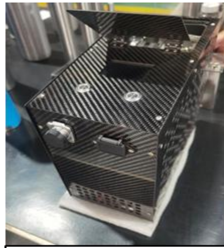
图 100 W燃料电池供氢系统
